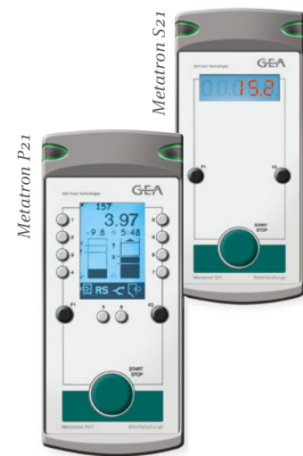
Management direkt vor Ort: Metatron P21/ S21 der „kleine PC im Melkstand“
