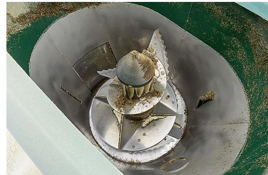
Im 2,2 m<sup>3</sup> großen Mischer befindet sich eine vertikale Mischschnecke. Die Stahlwanne selbst ist mit Edelstahl ausgekleidet.
