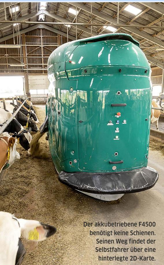
Der akkubetriebene F4500 benötigt keine Schienen. Seinen Weg findet der Selbstfahrer über eine hinterlegte 2D-Karte.
