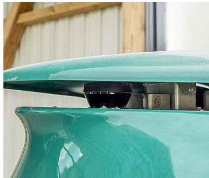
Unter der Haube befindet sich ein Laser, welche 2D-Karten durch das Scannen der Umgebung in bis zu 60 m Entfernung erstellt.
