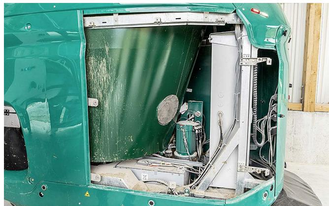
Hinter der Verkleidung befindet sich der Lithium-Akku für den Fahrtrieb sowie der hydraulische Antrieb für die Mischschnecke.
