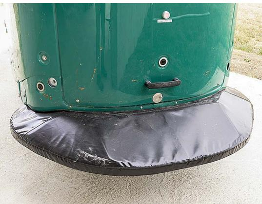
Ultraschallsensoren sollen Kollisionen mit Hindernissen auf dem Fahrweg verhindern. Zur Sicherheit sind unterm schwarzen Tuch zusätzlich mechanische Sensoren installiert.
